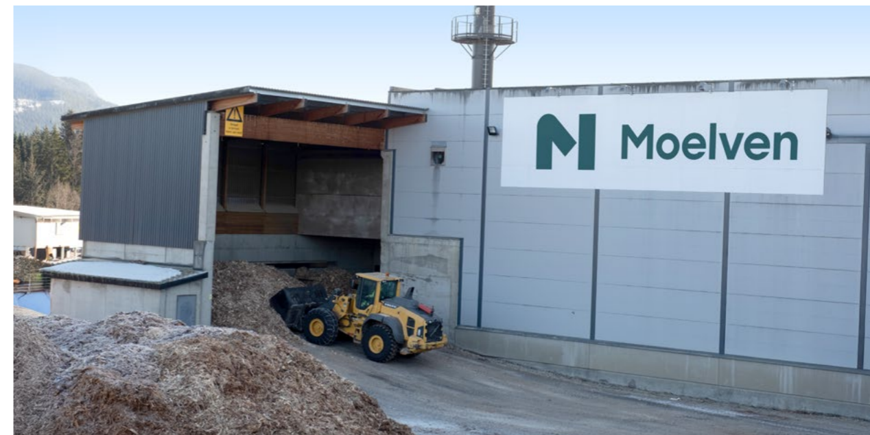
Lastning av biomassa vid Moelven Mjös bruket AS. Biomassan består huvudsakligen av bark från det sågade virket, blandat med andra träflis för att uppnå önskad fukthalt för förbränningsprocessen.
