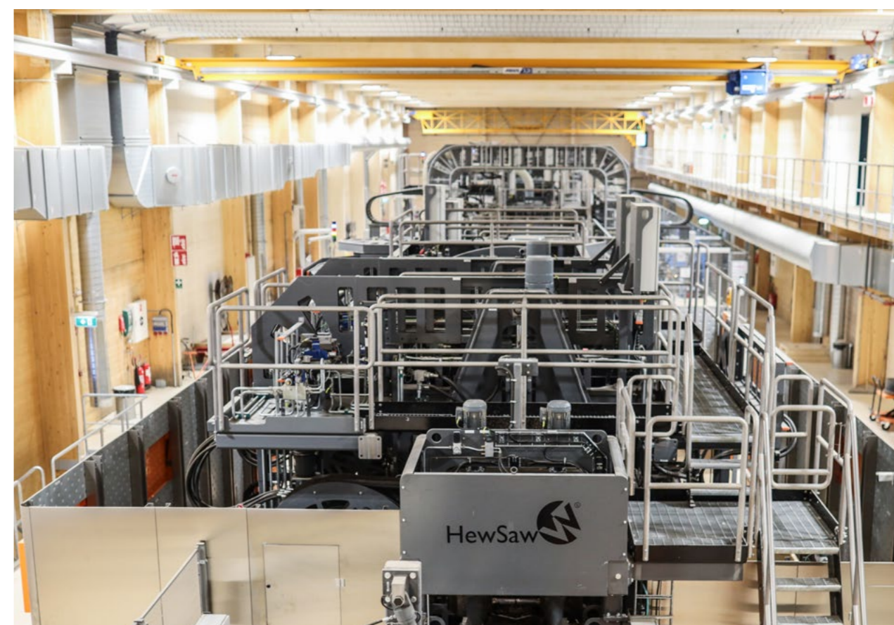
När Moelven Edanesågen AB investerade i en ny såglinje uppfördes den tillhörande byggnaden med en bärande konstruktion i limträ och vägg- och golvelement i massivträ, totalt 674 m 3 . De använda materialen binder biogent kol motsvarande cirka 470 ton CO 2 . Som jämförelse har World Population Review ( www.worldpopulationreview.com ) beräknat att de genomsnittliga CO 2 -utsläppen per capita i Norge och Sverige år 2023 var 7,8 ton respektive 3,4 ton.
