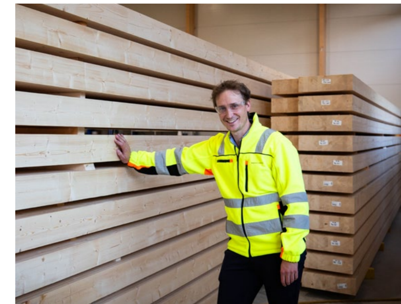
Tore Olsen Haglund, projektledare på Moelven Limtre AS, framhåller limträ som ett lämpligt material för höghustillbyggnader tack vare den låga vikten i förhållande till hållfastheten. – Man sparar både utrymme och material genom att utgå från befintliga byggnader.
